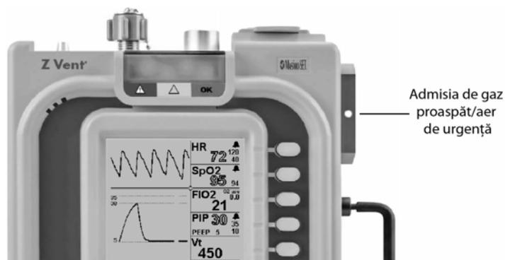
Figura 3-3 Admisia de gaz proaspăt/aer de urgență
