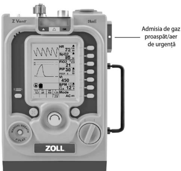
Figura 2-4 Admisia de gaz proaspăt/aer de urgență
